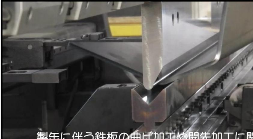
製缶に伴う鉄板の曲げ加工や開先加工に関しても
